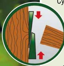
Сучкорезы и секаторы упорного типа способны сэкономить до 20% прилагаемых усилий по сравнению с заходным типом. Материал, который необходимо обрезать, располагается на «наковаленке». Такой инструмент идеален для обрезки твердых и засохших ветвей, а также кустарника. При этом обеспечивается защита рук от вибрации.
