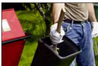
Два приемника для разных видов отходов: большой приемник для мелких веток и мусора и специализированный лоток для более крупных веток.
