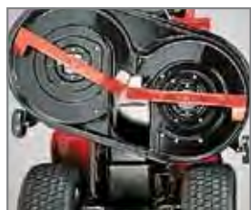
Тракторы с задним выбросом и двухножевой декой имеют ножи, которые вращаются навстречу друг другу и эффективно перемещают скошенную траву в травосборник
