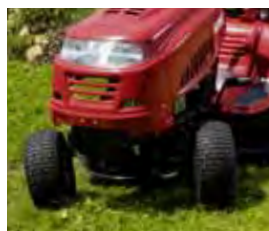
Передняя маятниковая ось для ровного и профессионального кошения даже на неровной поверхности
