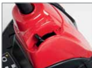
Шестиступенчатая трансмиссия Transmatic с переключением на ходу
