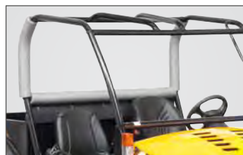
Прочный каркас, защита оператора при перевороте машины
